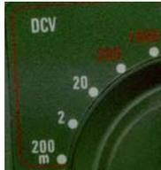
El latiguillo negro se pone en el COM y el rojo en la posición V. El selector se sitúa en la posición adecuada según sea el valor del voltaje a medir: DCV (continua), o ACV (alterna).
