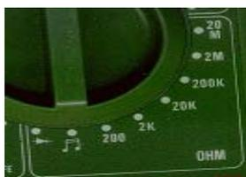
El latiguillo negro se pone en el COM y el rojo en la posición  $\Omega$  ó OHM, el selector se sitúa en la posición adecuada según el valor de la resistencia.
