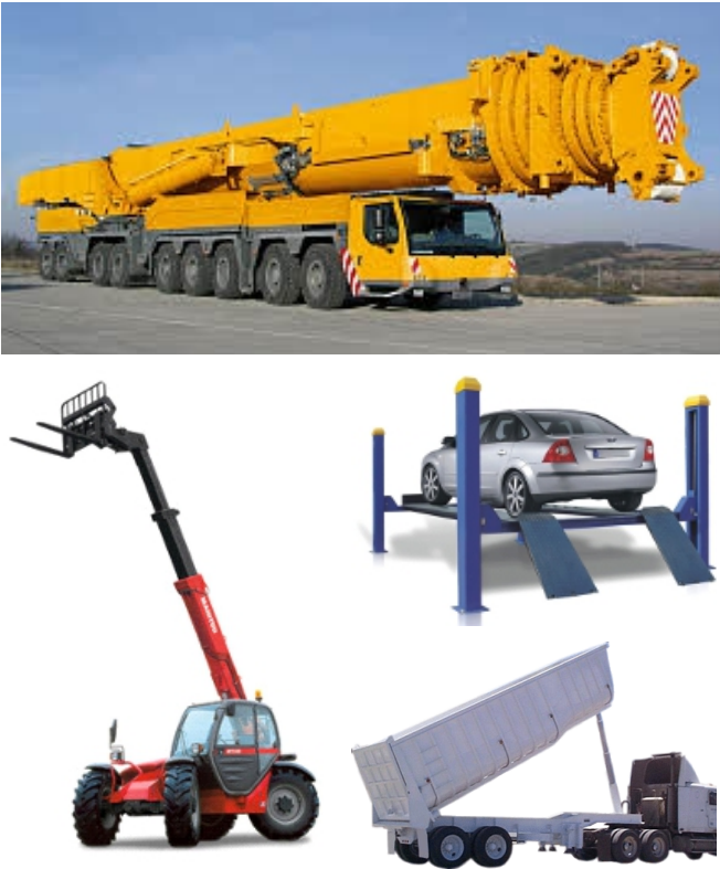
Fig 19: Ejemplos de aplicaciones de los circuitos hidráulicos
